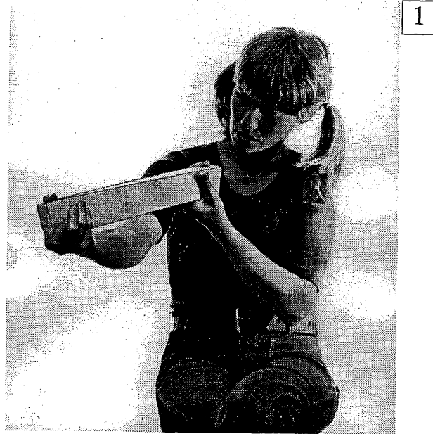
Fig. 1 Verwringing van een balkje, vervaardigd van polystyreenschuim
